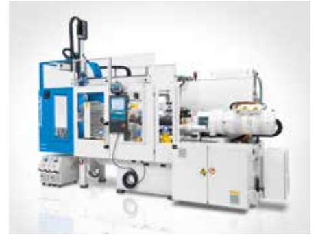
Lineer robot ile alınan parçalar: Enjeksiyon makinesinin standart koruyucu konveyör bant üzerine yerleştirilir.
