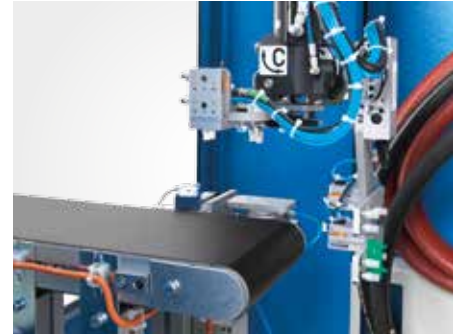
Koruyucu gövdeye entegre edilmiş kompakt konveyör bant.
